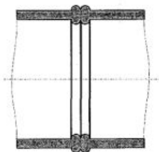
Слика 1: Скица на термо-дифузионен спој на полиетиленски цевки
